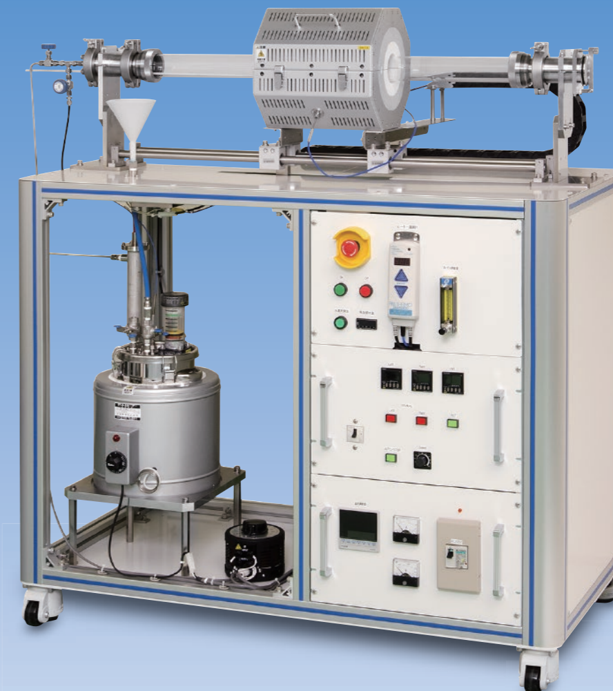
Heating/cooling cycle test specifications in water-vapor atmosphere 水蒸気雰囲気中における加熱冷却サイクル試験仕様
