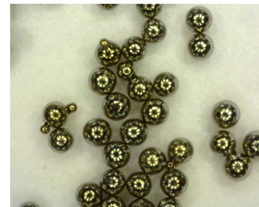
成膜後 (色から膜厚200nm程度と推定)
