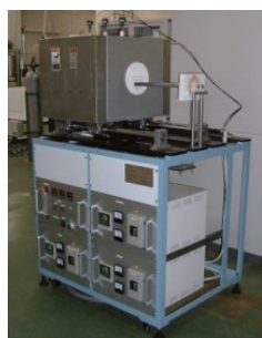
Heating/cooling cycle test in the atmosphere 大気雰囲気中の 加熱冷却サイクル試験
